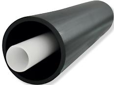
**Poly-Flo** 包含了一个由PE100-RC或PP-R制成的管道系统，它可以安全地传输危险性介质。它可以通过同步焊或者阶梯式焊接来方便的安装。介质管和保护管均可以承受较强的压力。
