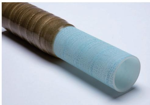
相比于传统的纤维背衬管，AGRU的PVDF HV衬管是一个比较经济实惠的选择。经过表面处理的PVDF管具有三维表面结构，能与GRP管道形成最佳的粘合。该管道系统可用于PVDF、PVDF-FLEX及PVDF-el材料，生产的管道直径可达到20-355mm。
