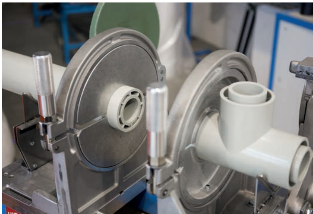
AGRU Ploy-Flo双层管道系统可以使用同步焊接，节约时间。
